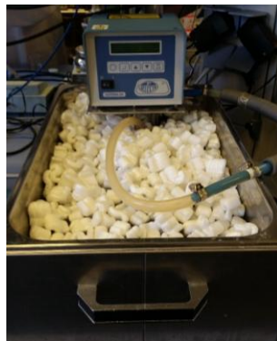
Figura XXIII: Baño termostático empleado en los calentamientos y enfriamientos del mosto.
