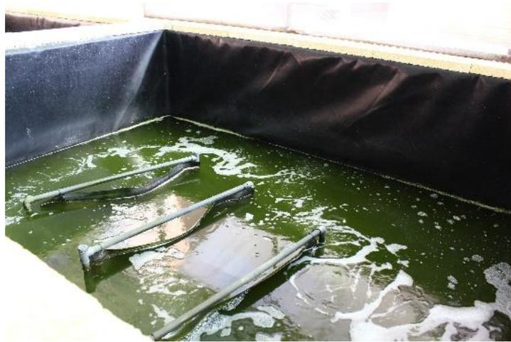
**Figura 3.2.** Aspecto de uno de los tanques (2240 litros), con aireación forzada.
