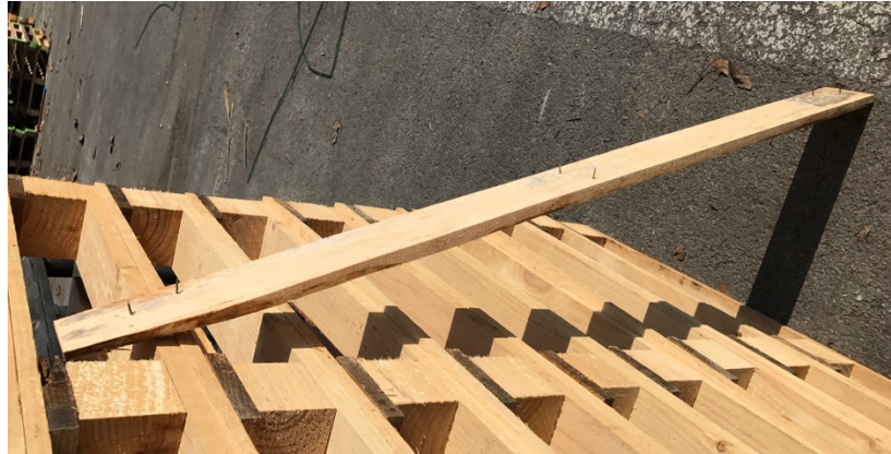
Figura 21. Palet con pocos clavos y demasiado cortos
