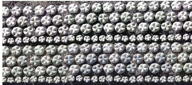
Fig. 32. Izquierda: elementos de hormigón desencofrados. Derecha: adoquines de hormigón preparados para recibir la arena que rellenará los huecos. Fuente: Pedro Lorenzo Gálligo 2005. Un techo para vivir.
