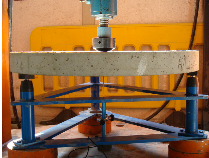
Figura 3. 19. Configuración del ensayo de la ASTM C 1550 (2005).
