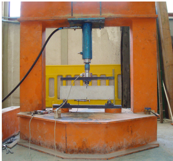
Figura 3. 7. Montaje de la probeta EN14651 (2005).
