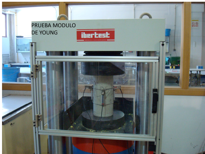
Figura 3. 6. Prueba para la obtención del módulo de Young.
