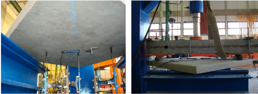
Figura 3. 38. Configuración de los captadores a) inferiores y b) superiores, del elemento Placa 2 HI1.
