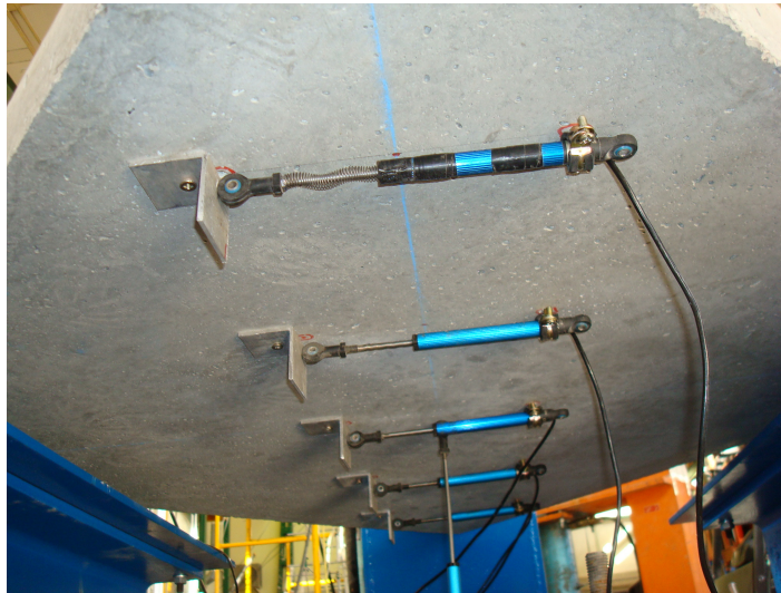
Figura 3. 28. Configuración de los captadores del elemento Placa 1 HI1.
