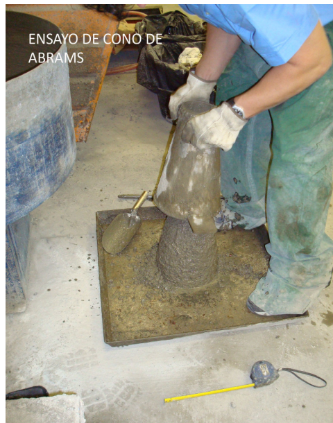
Figura 3. 5. Ensayo de cono de Abrams.
