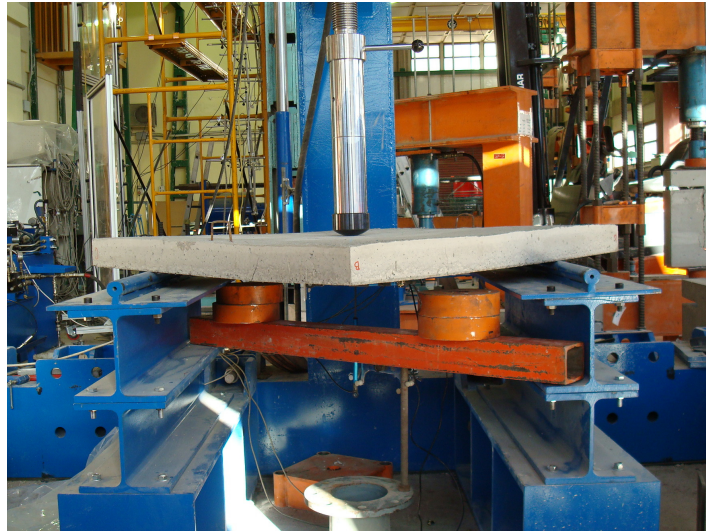
Figura 3. 25. Configuración de la prueba propuesta para la placa cuadrada con carga puntual en el centro.
