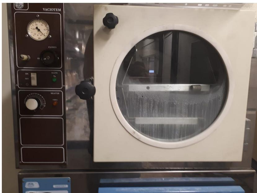
*Fig.2.5:* Estufa VACIOTEM-T, Modelo 400148
