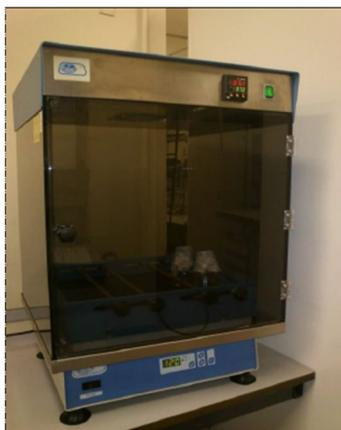
**Fig.2.4:** Cámara de incubación y agitador orbital (J.P. SELECTA)
