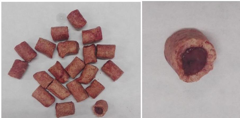
Figura 14. Aspecto de las muestras tras el secado a temperaturas por debajo del punto de congelación (-10 °C) hasta un contenido de humedad de 0,7 kg agua/kg ms.
