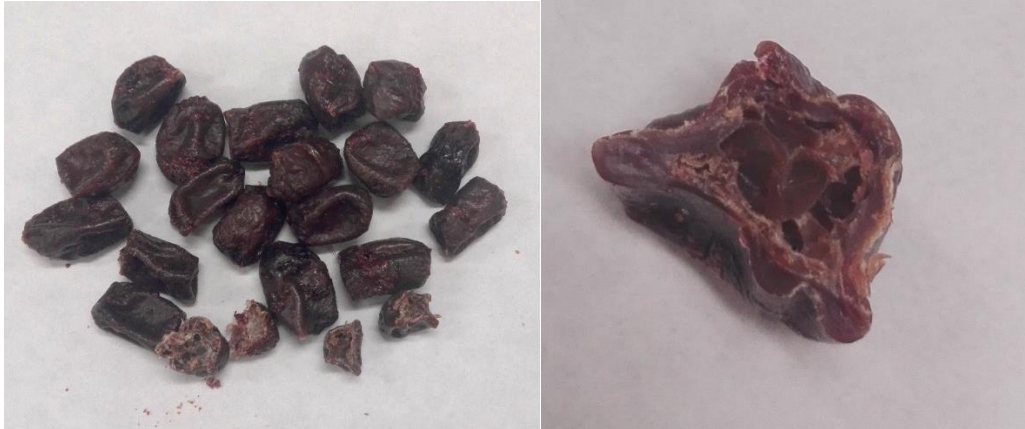
Figura 12. Aspecto de las muestras tras el secado a temperaturas mayores al punto de congelación para un contenido de humedad de 0,5 kg agua/kg de ms.
