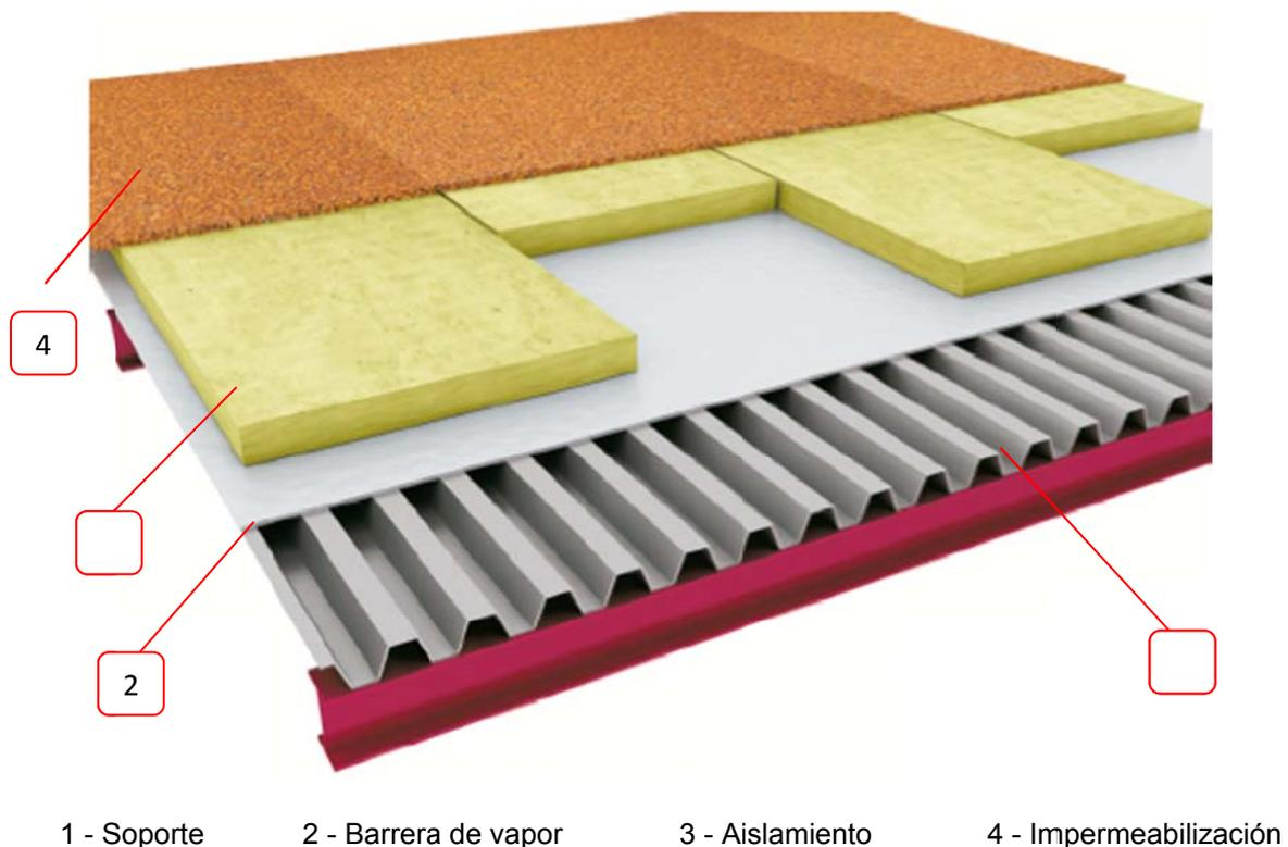
Figura 2. Detalle de la cubierta.
