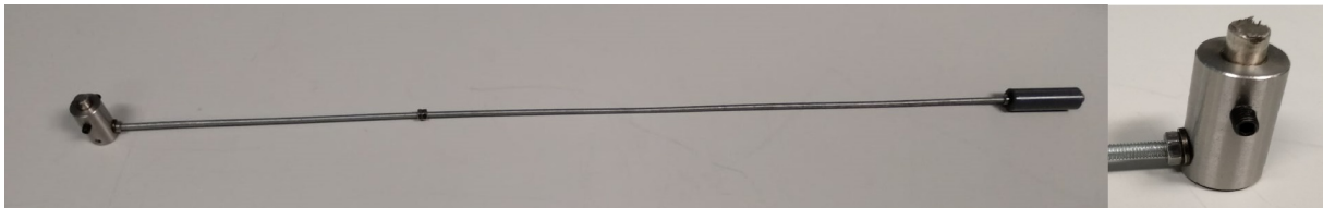
Figura 3.8: Varilla y casquillo utilizado para la sujeción del Imán
