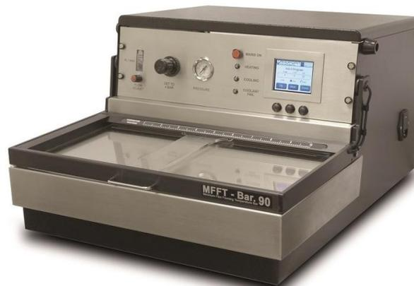
*Ilustración 17. Equipo de medición de temperatura mínima de formación de film [28].*
