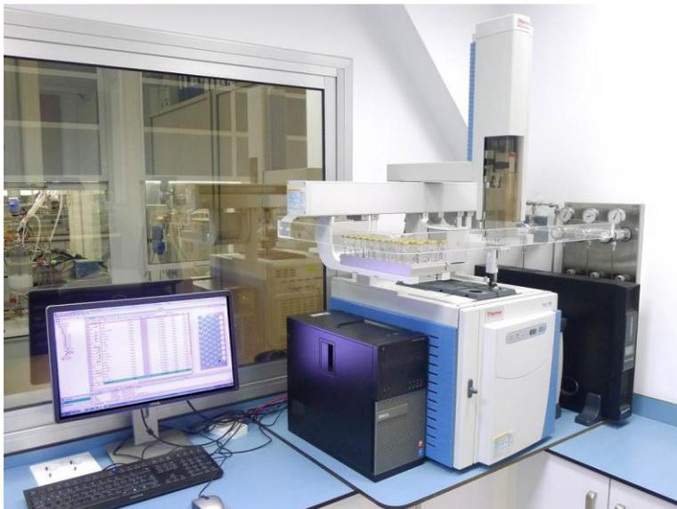
*Ilustración 16. Cromatógrafo de gases [Elaboración propia].*
