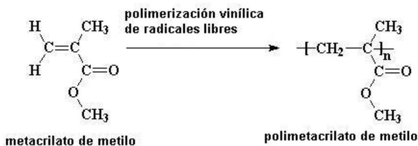
Ilustración 4. Esquema de polimerización del polimetacrilato de metilo [13].
