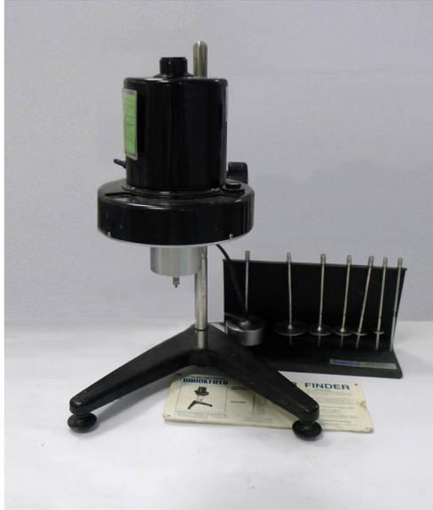
Ilustración 19. Viscosímetro Brookfield RVT [Elaboración propia].
