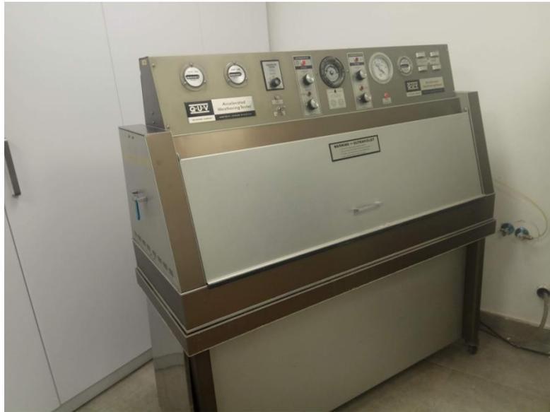
*Ilustración 23. Equipo envejecimiento artificial acelerado QUVmeter [elaboración propia].*
