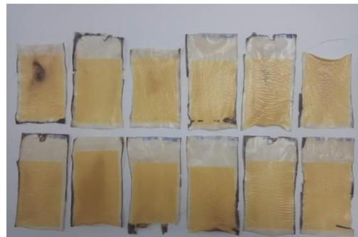
Ilustración 28. Probetas tratadas con Resina SBR.
