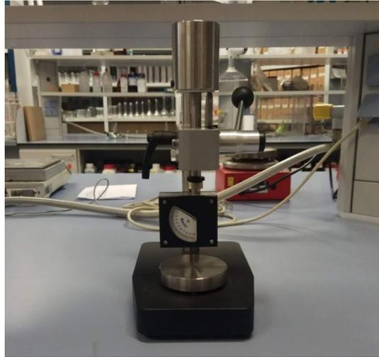
*Ilustración 25. Durómetro de medición de Dureza shore A [elaboración propia].*
