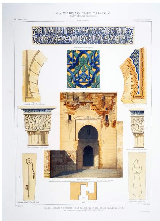
Figura 10. Planta, alzado y detalles de la Puerta de la Ley, vulgo de Justicia . En los Reales Alcázares en la Alhambra (Granada) Grabador Teófilo Rufflé Dibujante Rafael Contreras y Muñoz Cromolitografía Imagen obtenida de la web de la Calcografía Nacional http://www.tiendarabasi.com
