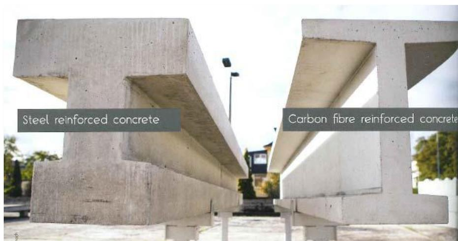
Ilustración 11: Comparación viga de hormigón armado con viga de hormigón y fibra de carbono.
