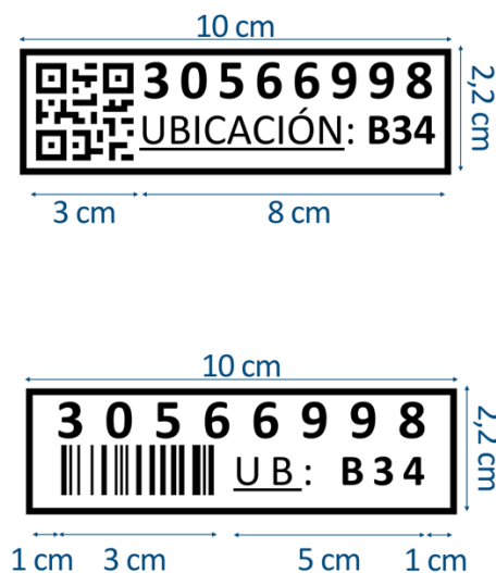
Figura 38 – Dos formatos posibles de etiquetas
