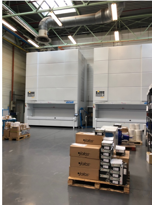
Ilustración 12 – Silos automáticos de marca MODULA
