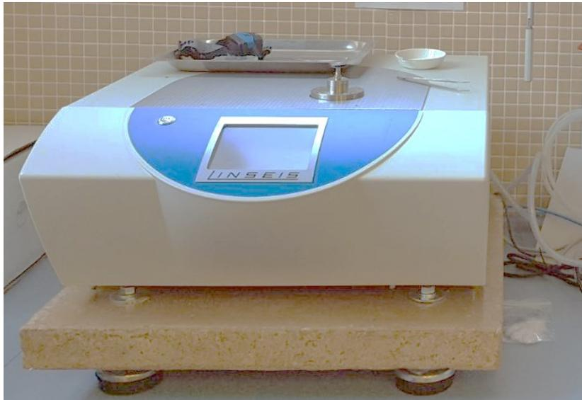
**Figura 22. Balanza termogravimétrica Linseis**
