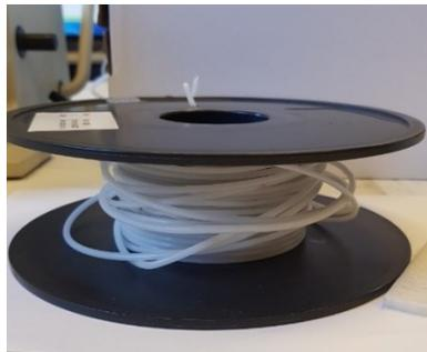
**Figura 35. Filamento de PCL**
