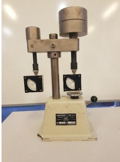
**Figura 27. Durómetro Instruments J Bot**
