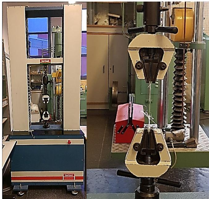
**Figura 23. Máquina universal de ensayos Ibertest Elib, con mordazas mecánicas**
