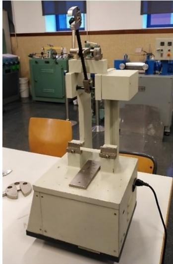
**Figura 18. Máquina de impacto Charpy Metrotec**
