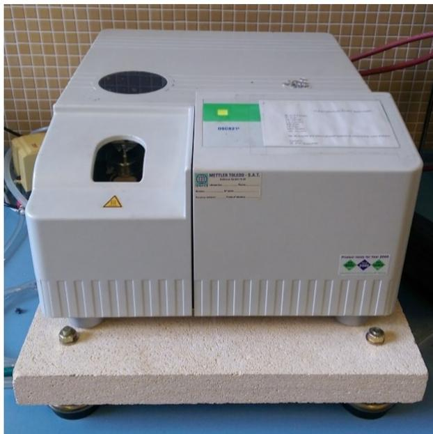
**Figura 21. Calorímetro diferencial de barrido DSC 821 Mettler-Toledo**
