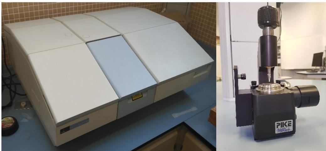
**Figura 29. Espectrómetro de infrarrojos por transformada de Fourier Perkin Elmer, modelo Spectrum BX y ATR PIKE**
