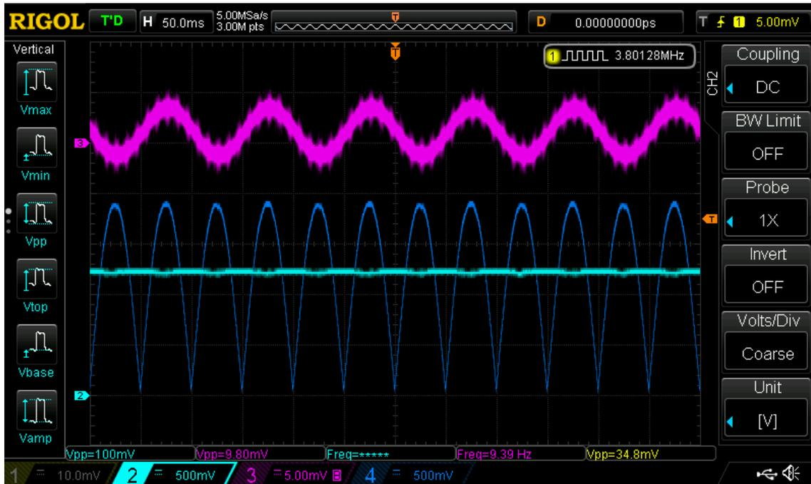
Figura 37. Señal obtenida en la etapa de rectificación (azul oscuro) y en la siguiente etapa de filtrado paso-bajo II (azul celeste).
