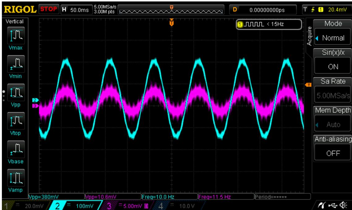
Figura 30. Señal obtenida en la etapa de amplificación diferencial.
