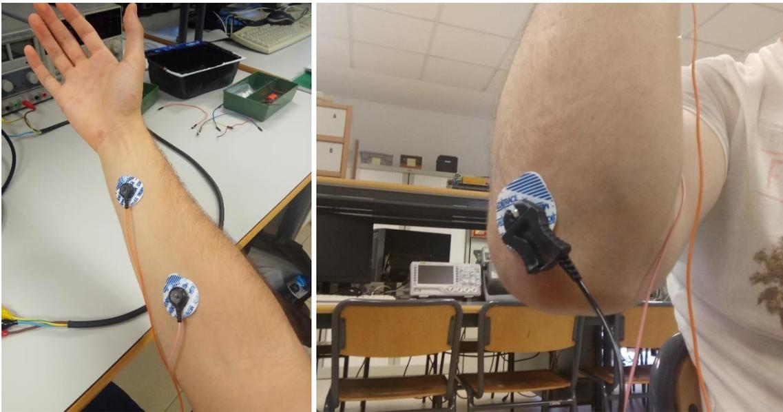
Figura 39. Disposición de los electrodos superficiales sobre el brazo derecho del individuo.
