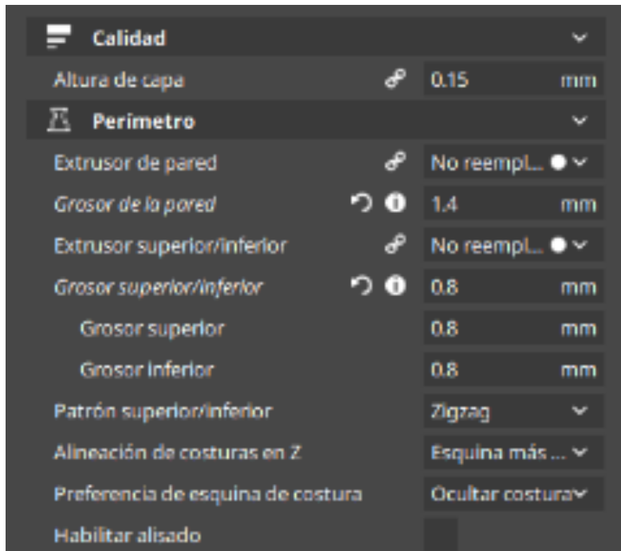
Figura III.52. Regulación parámetros de calidad y perímetro.
