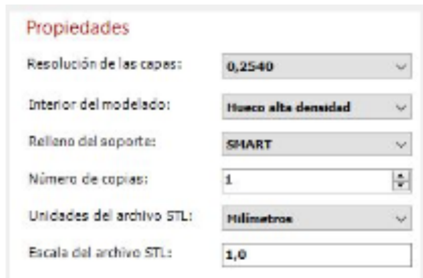
Figura III.56. Regulación parámetros de impresión software CatalystEx.
