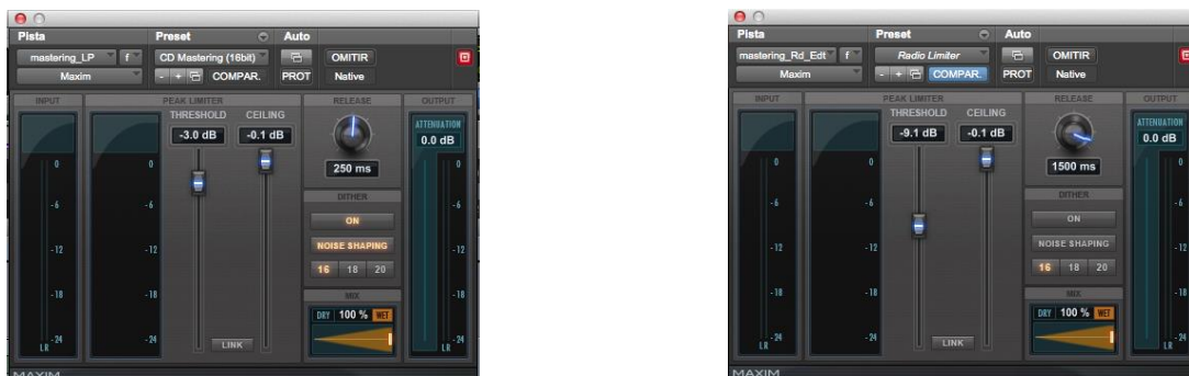
Figura 49. Detalle del maximizador con el preset de ‘CD mastering’ izquierda y ‘Radio limiter’ a la derecha.
