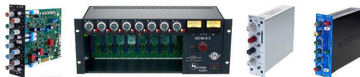
Figura 22. Ejemplos de la Serie 500: ecualizador SSL 611, Rack Heritage Audio MCM8 mk2, Preamplificador Neve Portico 511, Compresor/limitador Midas 522.
