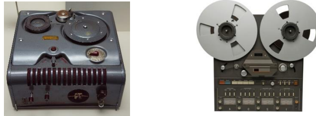
Figura 4. Ejemplos de primeros registradores: magnetófono de alambre y multipistas Ampex.
