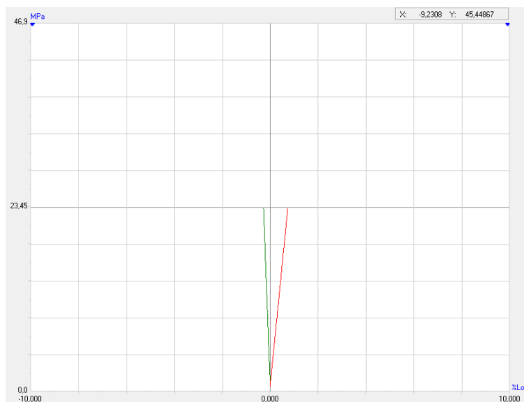
Figura IV. 10. Gráfico Tensión – Deformación Transversal Longitudinal, obtenido del software controlados de la máquina universal de ensayos Elib 50. A partir de este gráfico se puede obtener el Módulo de Elasticidad de forma más precisa.
