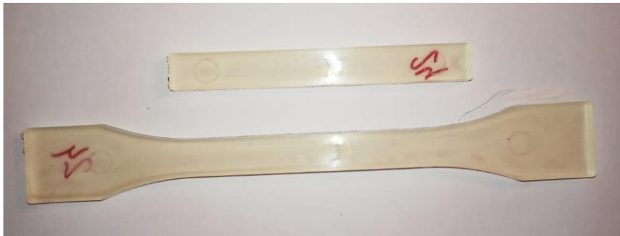
Figura III. 1. Muestras obtenidas del proceso de inyección. En la imagen se puede observar una probeta para tracción y otro para impacto y flexión.
