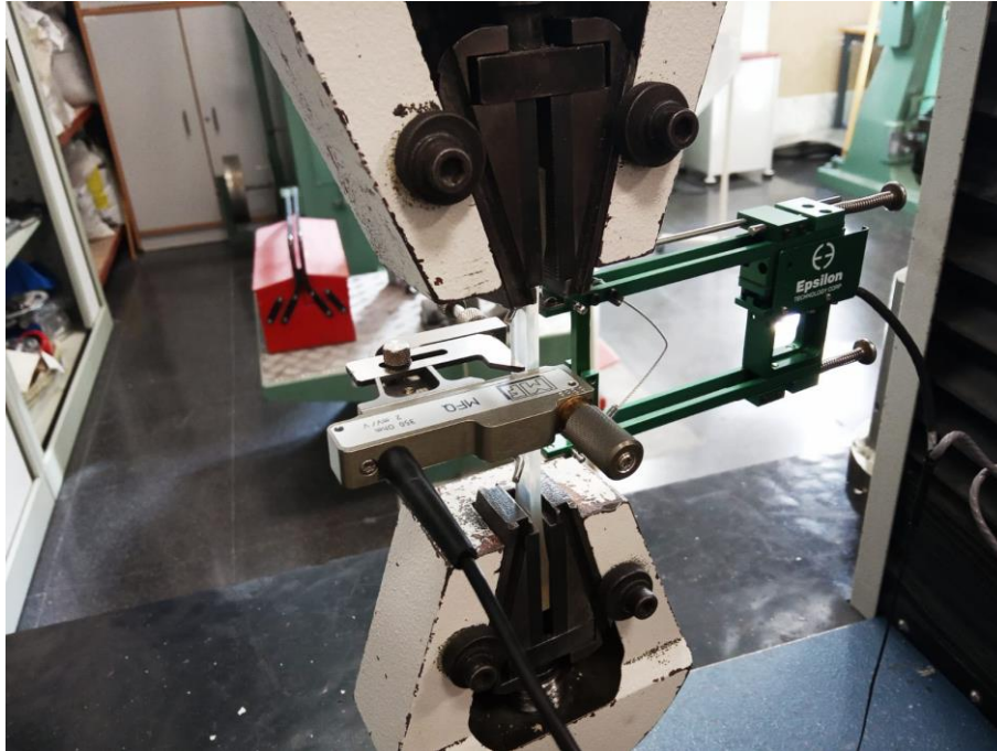
Figura III. 4. Colocación del extensómetro y el captado MFQ.
