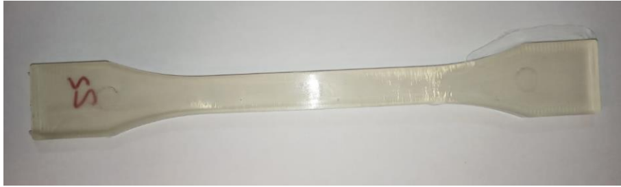
Figura IV. 9. Probeta ensayada al 60% de deformación.
