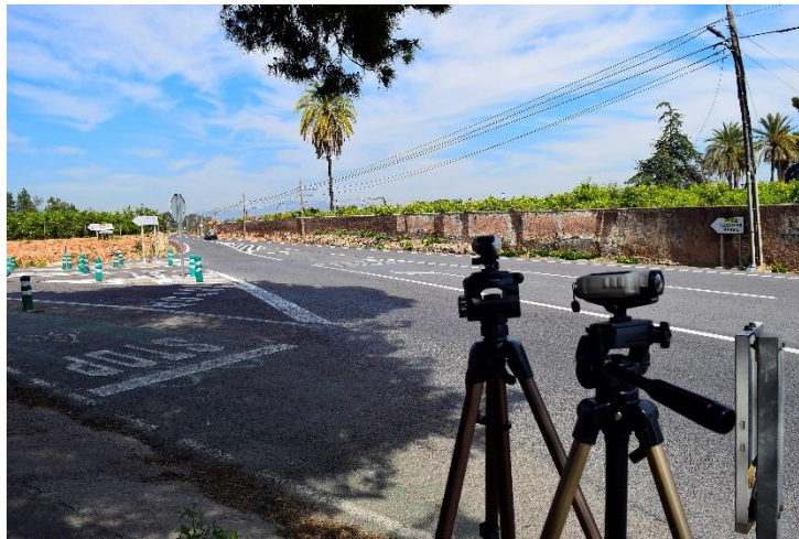
Fig. 47 Cámaras preparadas en la intersección I22
