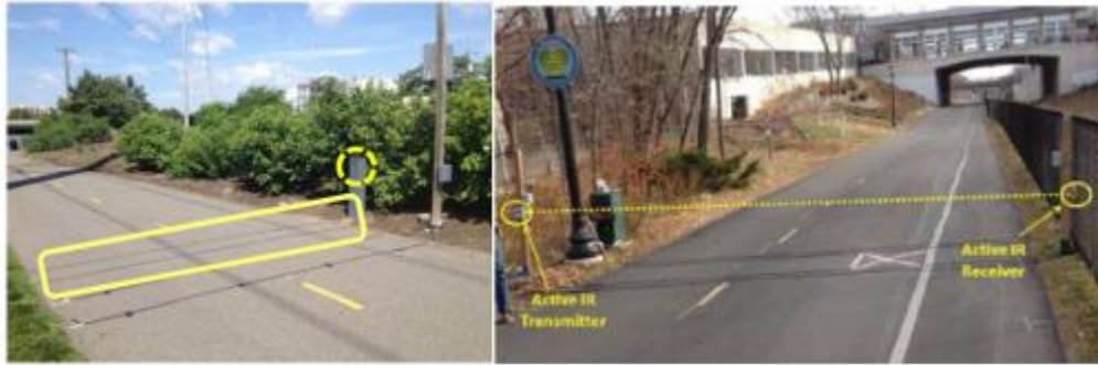
Fig. 20 Ejemplos de sensores infrarrojos pasivos vs. activos (Ryus et al., 2017)
