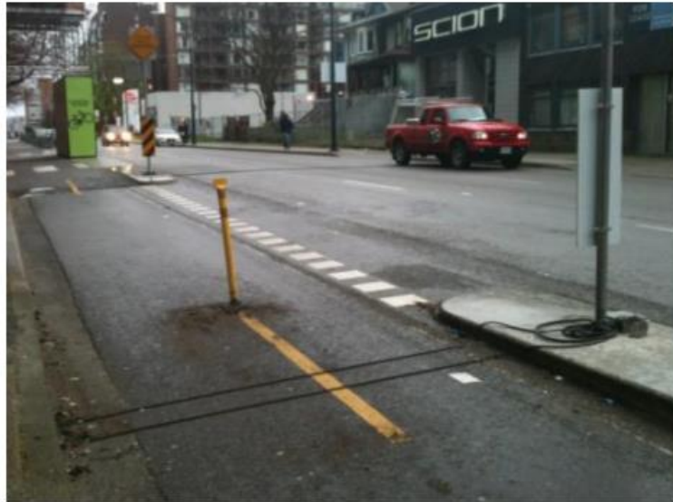
Fig. 22 Ejemplo de configuración de tubo neumático para el conteo direccional del tráfico de bicicletas (Jean-Francois Rheault, Eco-Counter)
