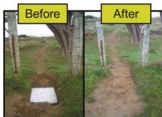
Fig. 23 Ejemplos de sensores de presión sobre un suelo natural (Jean-Francois Rheault, Eco-Counter.)
