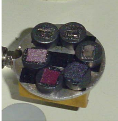
Figura 21 Muestras preparadas para ser analizadas en SEM/EDX.
