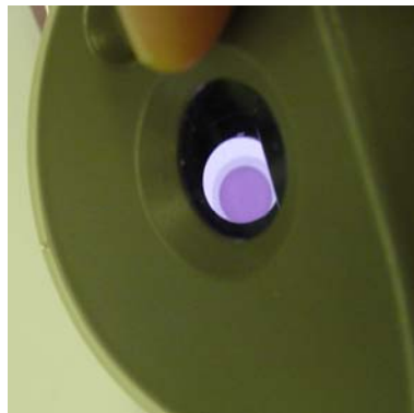
Figura 18 Visor para el ajuste de la probeta
