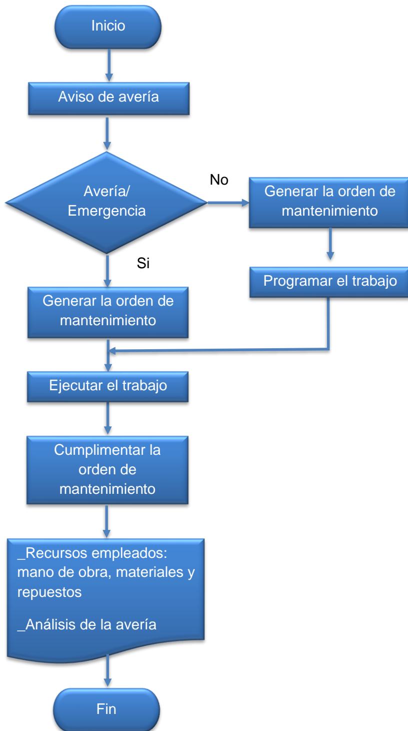
Figura 39. Flujo del mantenimiento correctivo
