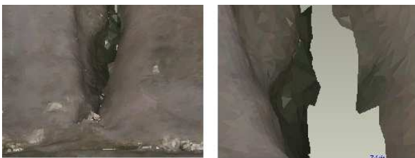
Figura 1. El modelo de la izquierda presenta una fisura (imagen de la derecha) que solo es apreciable cuando se introduce la cámara en su interior.
