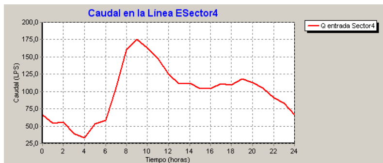
Fig 25 Caudales de entrada en el Sector 4
