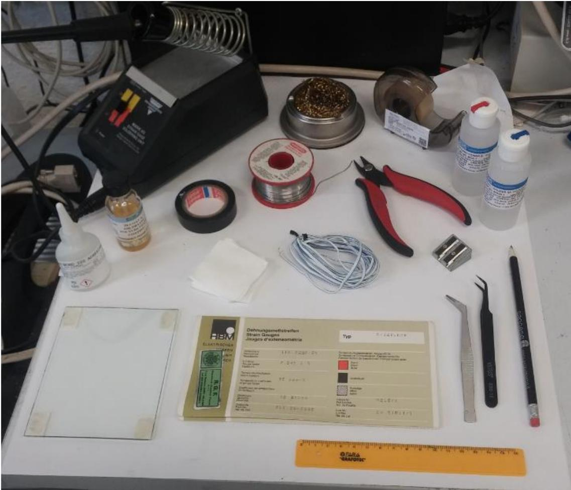
Fig. 4.2.1 Attrezzatura per applicazione estensimetro
