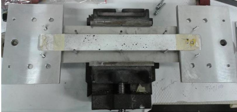
Fig. 4.3.1 Posizionamento provino sull'allineatore
