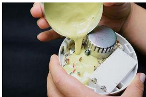
Figura 1.5 Resine per sigillatura ed incapsulato
