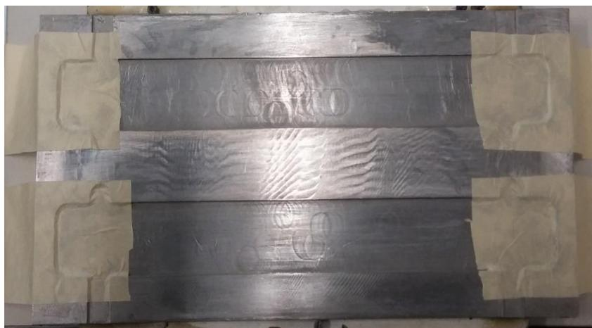
Figura 4.1.4 Applicazione del nastro
