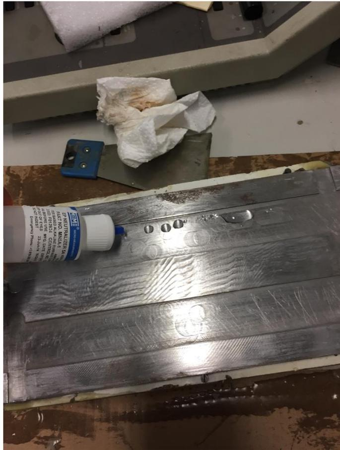
Figura 4.1.3 Applicazione M-PREP NEUTRALIZER
