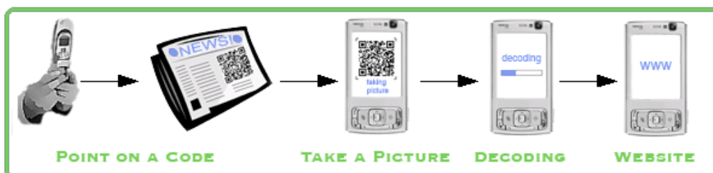
Figura 15 – Esquema de lectura de un código QR. Extraído de: http://en.wikipedia.org/wiki/Mobile_tagging
