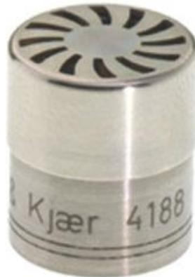
Figura 10. Micrófono de condensador prepolarizado Brüel & Kjaer 4188
