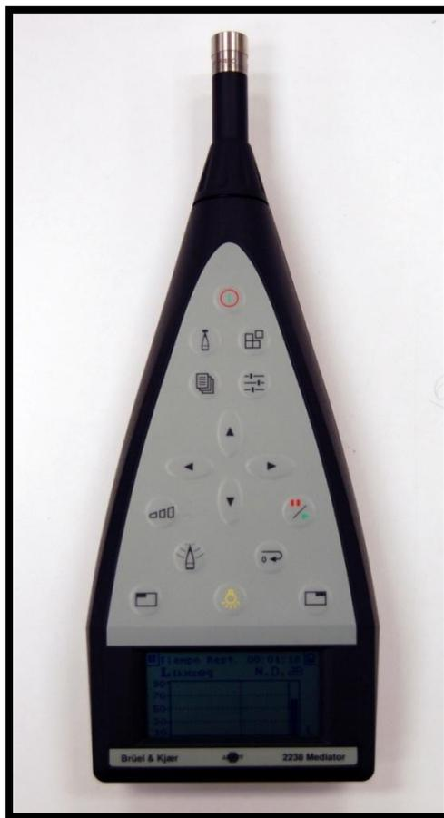
Figura 8. Sonómetro integrador utilizado, Brüel & Kjaer 2238 Mediator
