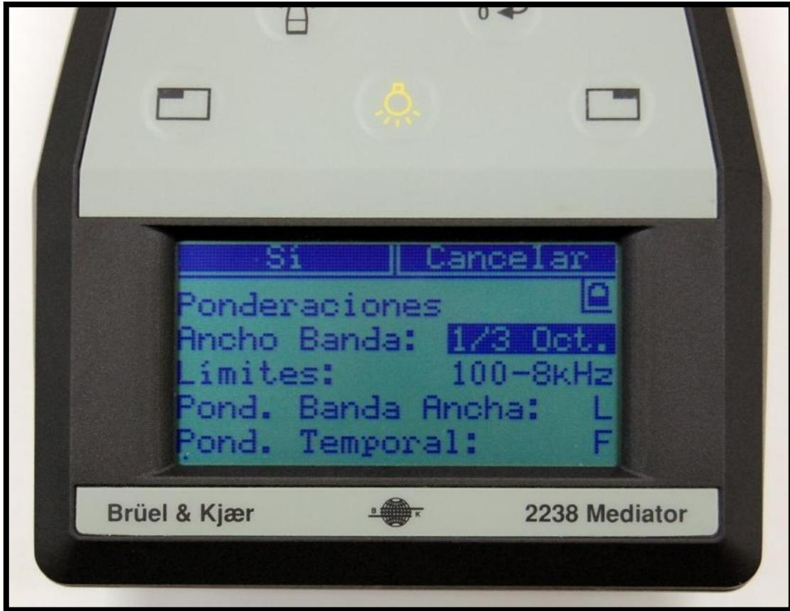
Figura 9. Vista de la pantalla del sonómetro integrador utilizado
