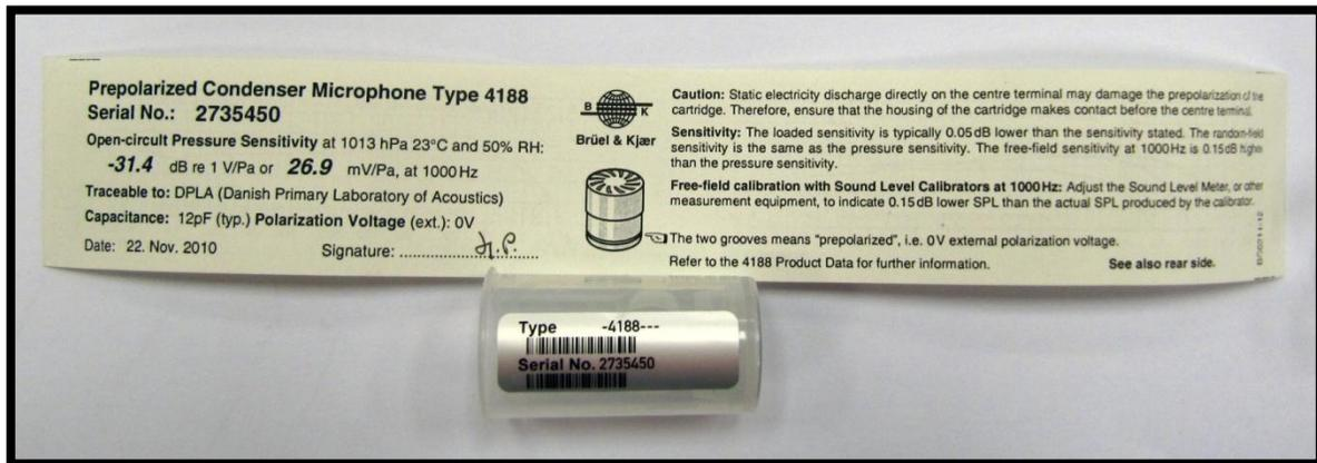
Figura 11. Hoja de especificaciones y datos de interés del micrófono Brüel & Kjaer
