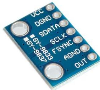
Figura 68. Generador de señales programable.
