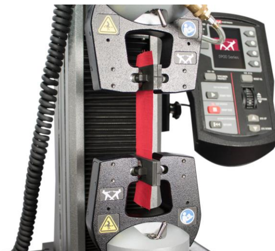
Figura V.6. Ensayo de tracción y elongación (Instron, 2020)
