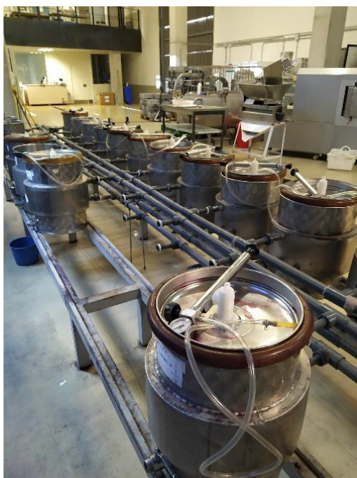
Figura 2. Depósitos de acero inoxidable utilizados en las experiencias y situados en la planta piloto del Instituto de Ingeniería de Alimentos para el Desarrollo, Universitat Politècnica de València.
