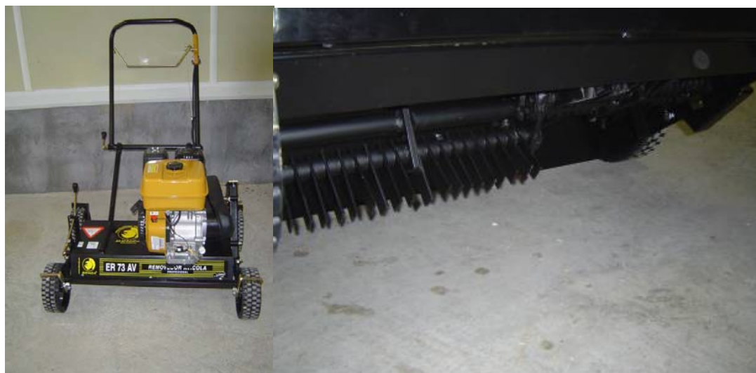
Figura 3. Máquina utilizada para realizar el volteo de la cama y detalle de las cuchillas metálicas.
