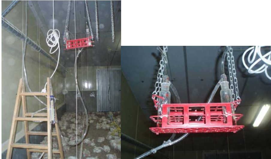
Figura 7 Impingers situados en una sala
