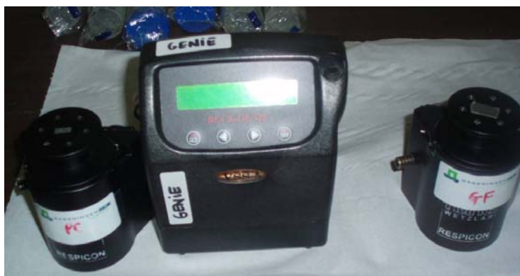
Figura 6. Bomba manual de succión e impactadores en cascada (RespiCon)
