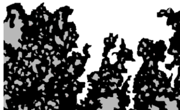
Figura 2.8.1. Esquema de una sección de gránulo de carbón activado donde se observan en blanco os poros abiertos y en gris los cerrados.
