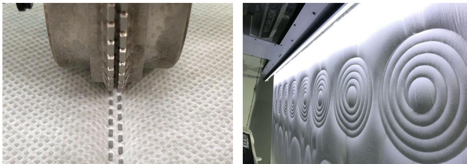
Figura 3.1.5. Unión mediante ultrasonidos y mediante cosido. Fuente: https://www.optron.es
