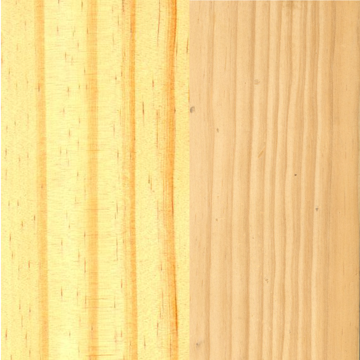
Foto 31: Aspecto macroscópico de la madera de pino insignis y de una pieza con madera de compresión
