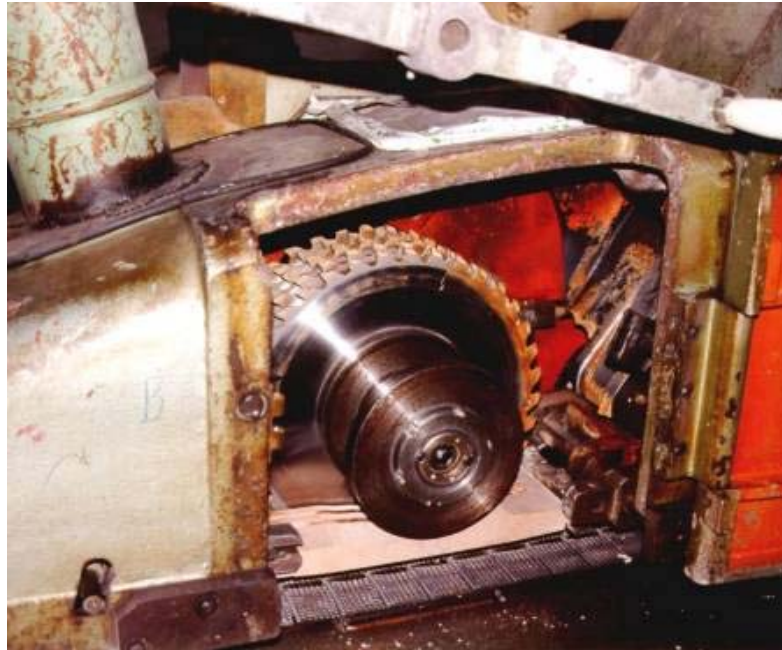
Foto 17: Mecanizado de una testa en cola de milano
