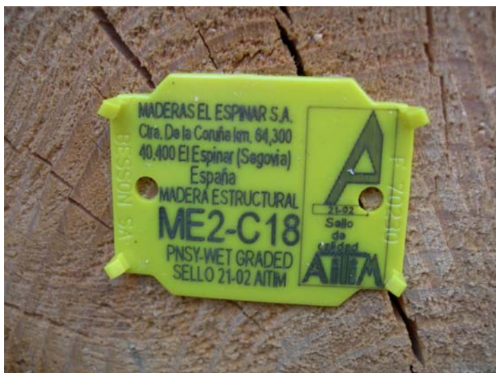
Foto 11: Ejemplo de marca del aserradero de El Espinar de una viga estructural C18, homologada por el organismo de control AITIM, con el número 21-02
