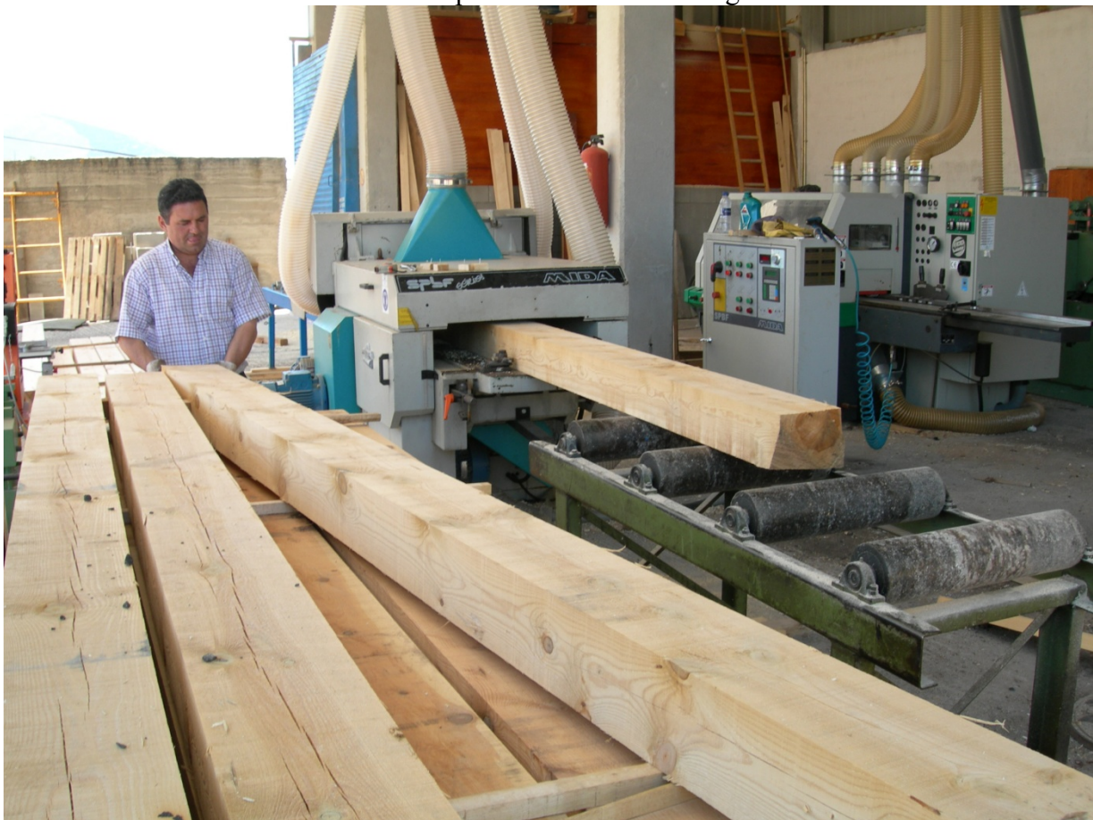
Foto 20: Cepillado 4 caras de una viga
