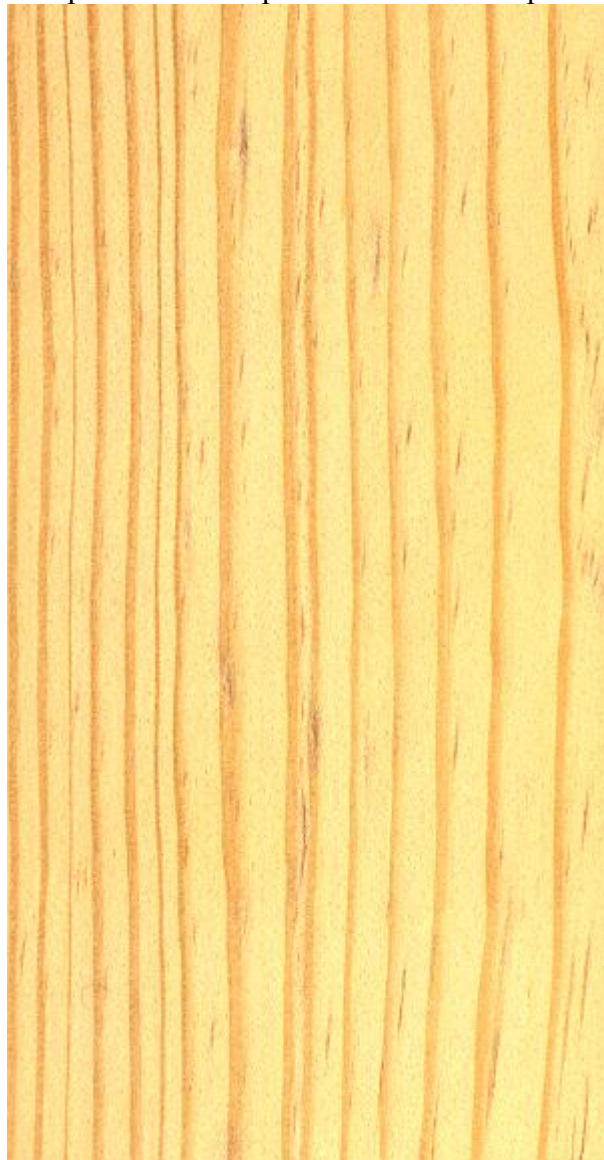
Foto 45: Aspecto macroscópico de la madera de pino carrasco
