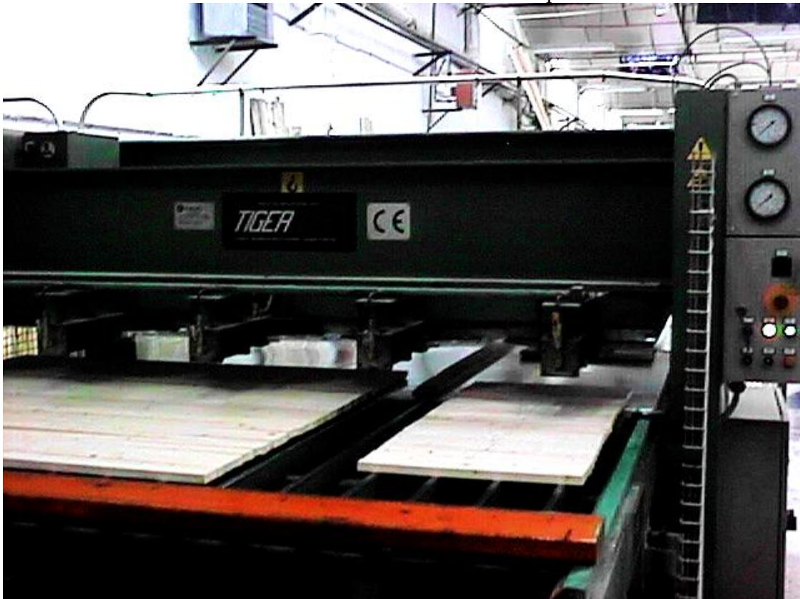
Foto 26: Fabricación de tablero alistonado de pino silvestre
