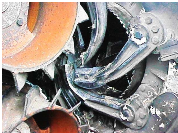
Foto 14: Cuchillas de descortezado
