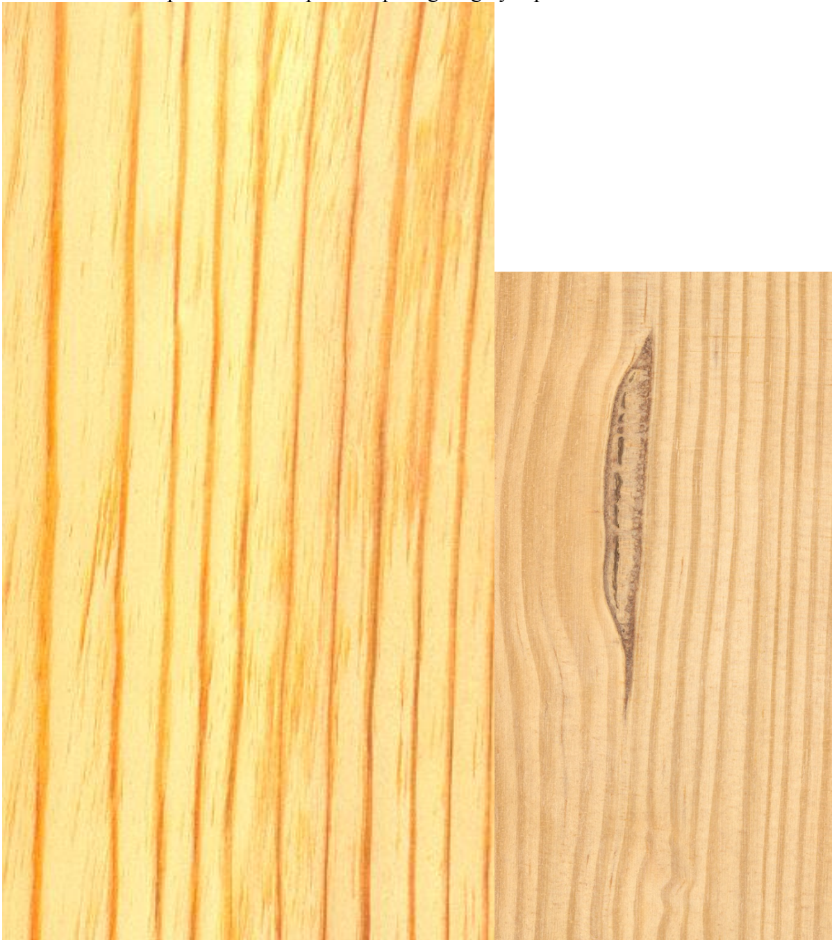
Foto 40: Aspecto macroscópico del pino gallego y aspecto de una bolsa de resina
