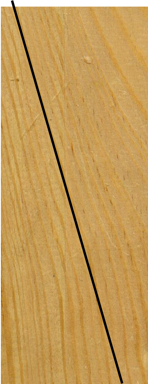
Foto 7: Inclinación de la fibra
