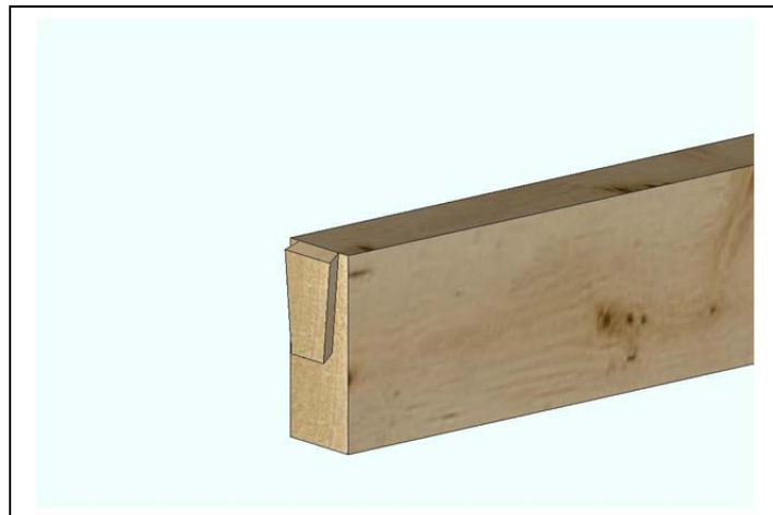
Foto 17: Mecanizado de una testa en cola de milano
