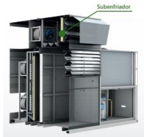
Figura 5. Ubicación del subenfriador en el roof-top [10].
