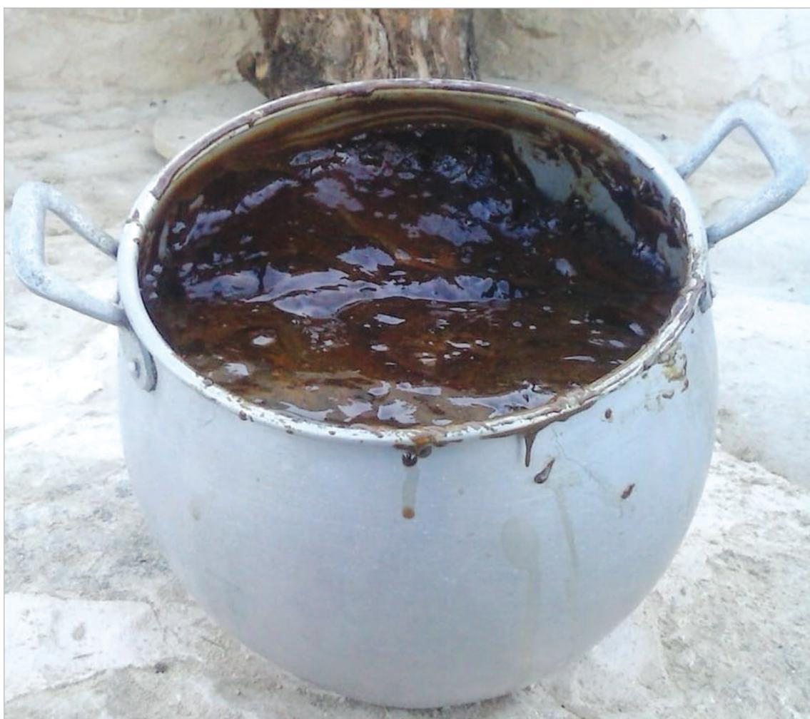
**Figura 7.** Detalle de un recipiente lleno de alquitrán de *Pinus halepensis* elaborado en una hornada de prueba realizada en febrero de 2019.
