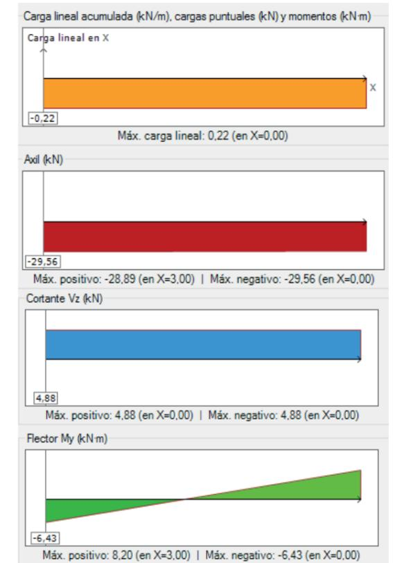
El pilar más desfavorable de todo el módulo cumple para ELU B3, así como todo el resto de elementos verticales e inclinados. La sección óptima para este pilar sería 80.80.6.
