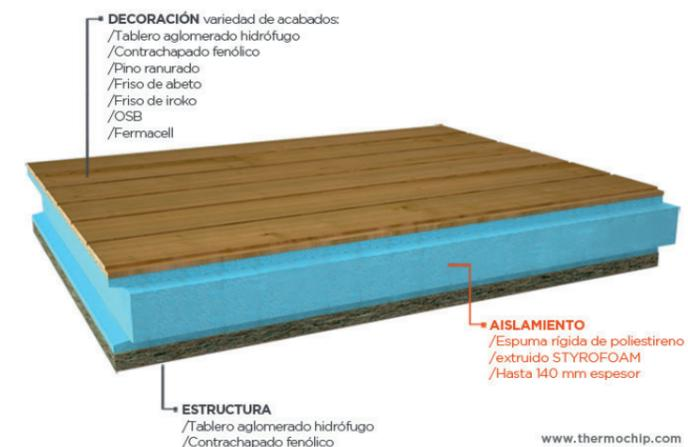
Para su colocación, en cerramientos lo fijaremos en su parte superior e inferior a la subestructura de madera que proporciona el revestimiento interior si lo hay, sino, lo colocaremos fijado a la estructura de metal, fijándolo también al panel contiguo mediante tornillos. En su posición horizontal, tanto en cubierta como en pavimento, se fijará a las correas, dejando siempre el macho en la parte superior.
