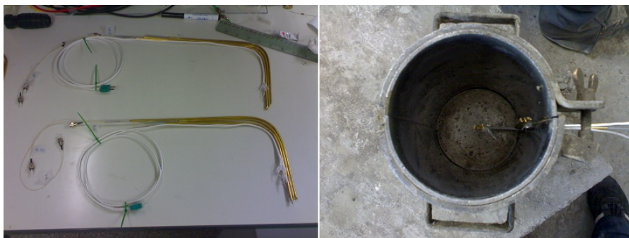
Figura 3.43. Grupo de sensores fabricado para facilitar la instalación
