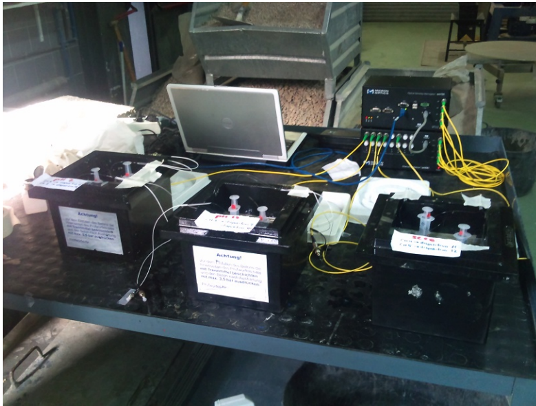
Figura 4.14. Instalación de los sensores ópticos de pH en las probetas de hormigón.
