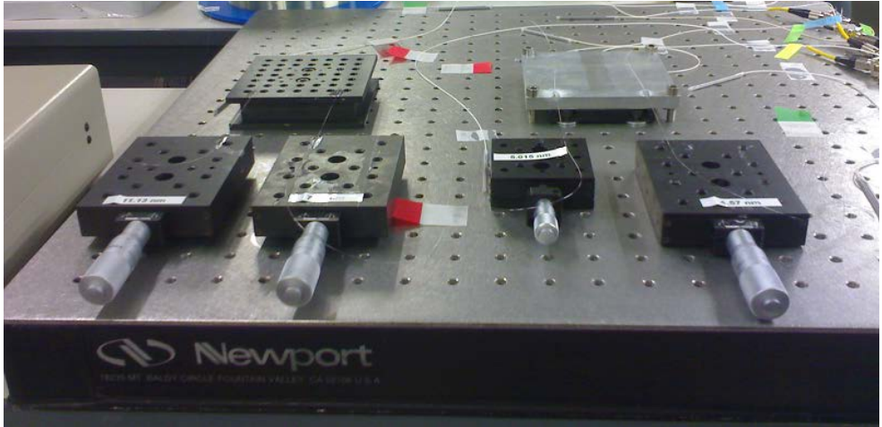
Figura 2.15. Fibras ópticas usadas como regiones de monitorización instaladas sobre un sistema de posicionamiento milimétrico.
