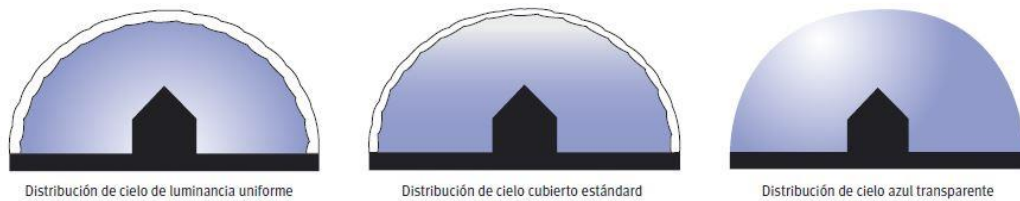
Fig. 9. Representación de diferentes tipos de distribución de luminancias en el cielo.
