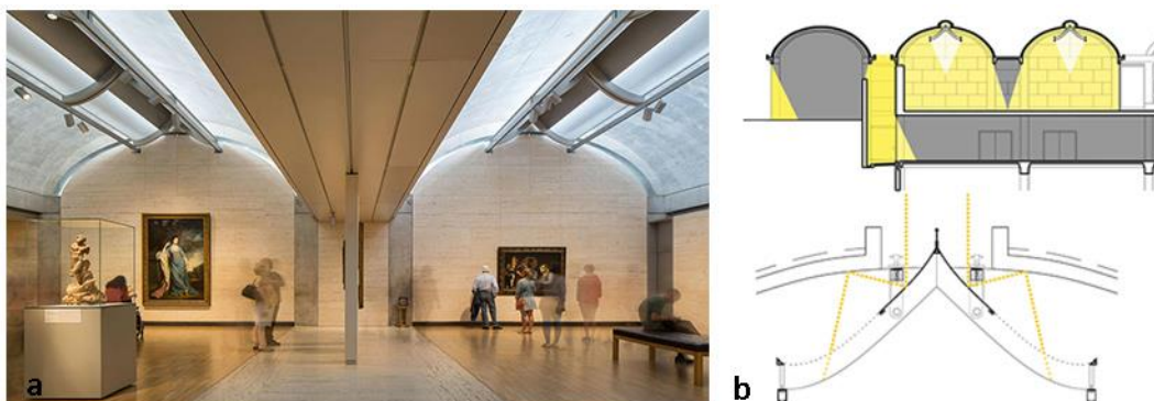
Fig. 4. a. Espacio interior del Kimbell Art Museum. b. Sistema que integra la estructura y la iluminación.
