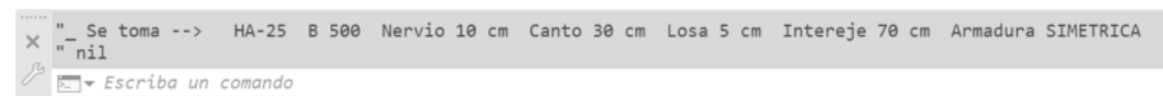
Figura 7. Cuadro de diálogo para verificar que el tipo de forjado elegido es correcto
