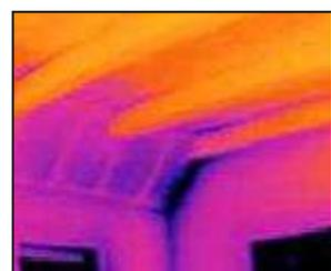
*Infiltración de aire en la unión entre la vigueta y la fábrica*
