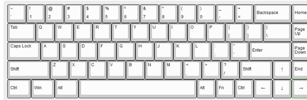
Figura 59. Formato 65%, en el cual se eliminan las teclas función, el teclado numérico y parte de la isla auxiliar entre el teclado principal y el numérico, además de fusionar parte de la isla auxiliar junto con las flechas a la derecha de la isla principal.
