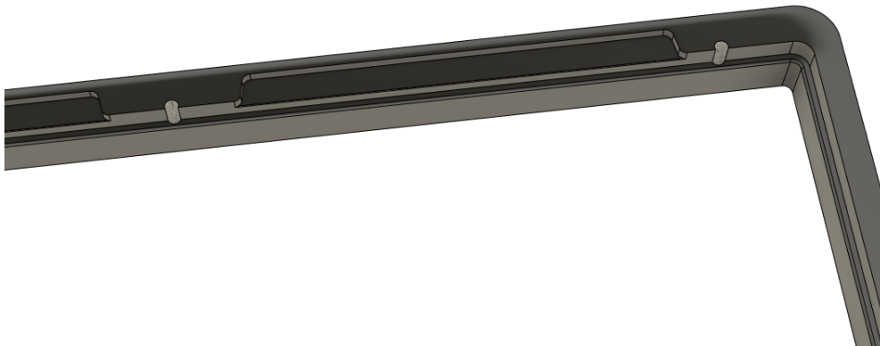
Figura 37. Agujeros para atornillado en la parte superior izquierda de la carcasa superior. Vista trasera en perspectiva axonométrica.
