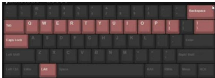
Figura 53. Programa VIA empleado para comprobar el funcionamiento de una PCB. Teclas ya comprobadas resaltadas en rojo.
