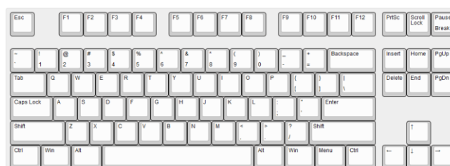
Figura 58. Formato TKL, en el cual se elimina el teclado numérico de la derecha.
