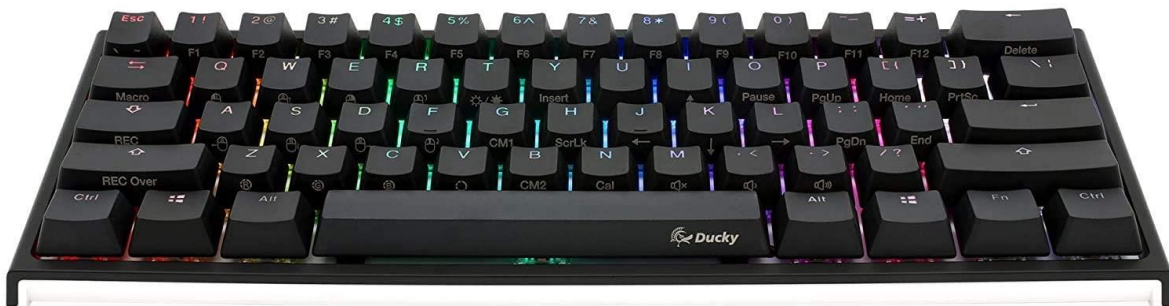
Figura 61. Ejemplo funcionalidad extra impreso en el lateral de teclas junto con la implementación de la tecla FN (abajo a la izquierda) en teclado Ducky One 2 Mini (60%).
