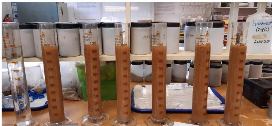
*Ilustración 2: Imagen con las probetas de 1L que contienen la solución Hexametafosfato sódico, agua destilada y 40gramos de suelo.*
