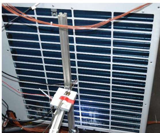
Figura 27. Generación de escarcha en la parte inferior del evaporador
