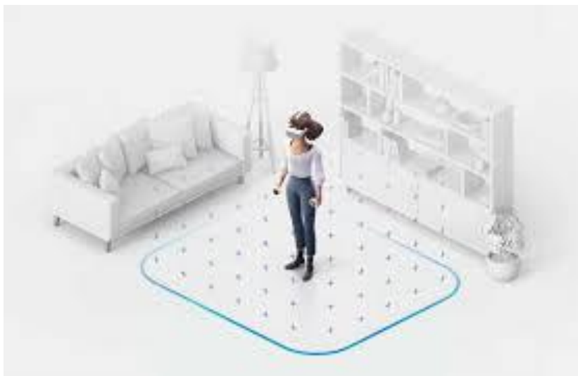
Figura 51. Dibujo en el suelo de los límites del sistema guardián.
