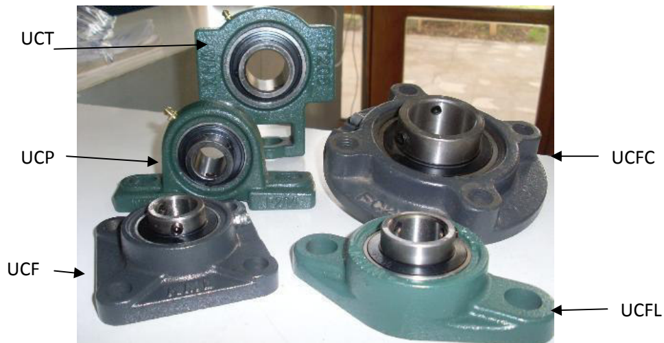
Fig. 10.1 Diferentes modelos de soporte de rodamientos: UCP, UCF, UCFL, UCFC, UCT.
