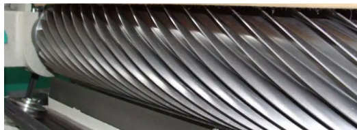
Imagen 47: Rodillo con cuchillas de la tundidora
