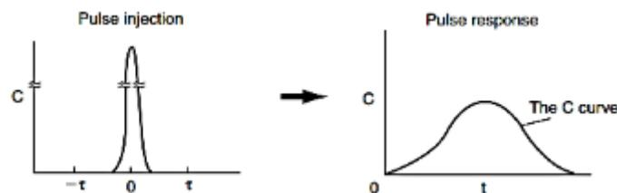
**Figura 4.** Función obtenida de experimentos de trazador por pulso.
