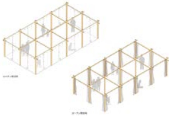
Esquemas del sistema de Partición de Papel. http://www.shigerubanarchitects.com/works/2016_Ecuador2/07 . JPG
