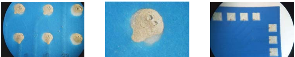
Figura 3.13 Detalles al microscopio del electrodo extraplano antes de clorado y conexionado (versión de 16 contactos). Electrodos (izq. y centro) y pads para soldadura (dcha.)
