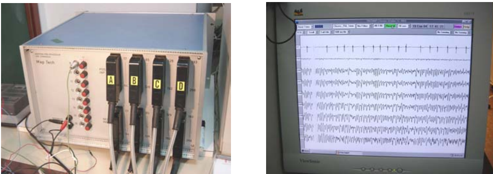
Figura 3.22 Sistema de adquisición MapTech . Caja de amplificadores y digitalización con los conectores de los electrodos (izq.) y software PaceMap ® de representación y análisis (dcha.)
