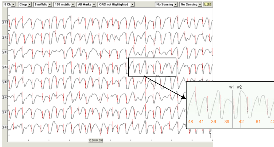
Figura 3.43 Marcado semiautomático de los instantes de activación en el programa PaceMap®. Se muestran 8 de los electrogramas de la zona modificada (1 segundo en pantalla). Detalle: La marca se sitúa en la máxima pendiente dentro de la ventana w1-w2. Se indican los intervalos VV
