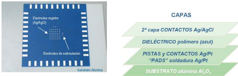
Figura 3.14 Electrodo de 36 contactos (fotografía antes de soldadura y ensamblado) y capas utilizadas en su fabricación mediante tecnología thick-film
