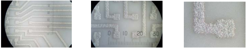
Figura 3.16 Detalles al microscopio del electrodo extraplano en la versión de 36 contactos. Primera capa antes de protector (las unidades de la graduación sobreimpresa corresponden a centenares de micras)
