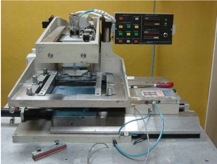
Figura A.47 Máquina semiautomática AUREL® C1010, utilizada en la serigrafía de los electrodos
