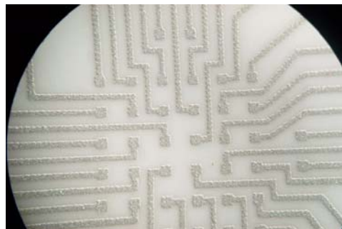
Figura 3.15 Vista al microscopio de la matriz de electrodos, en la versión de 36 contactos. Primera capa, antes del protector
