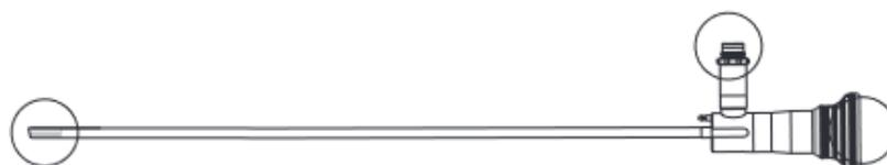
Figura 3. Ópticas del endoscopio: Ventana del objetivo (extremo.izq), Ventana ocular (extremo.der), Conector guía de la luz(centro) [14]
