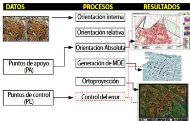
Figura 11. Fases del proceso fotogramétrico digital [16]
