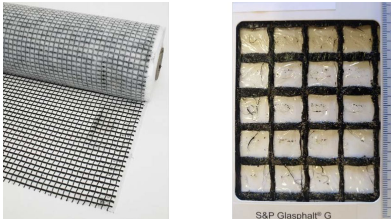
Figura 51: Malla de refuerzo. Fuente López-Bachiller, M. et al (2018).
